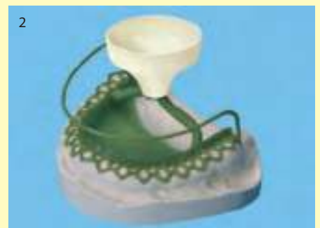
В процессе литья сжатый воздух вытесняется в воздуховыводные каналы, способствуя получению отливок без усадочных раковин, которые легко припасовывать.
