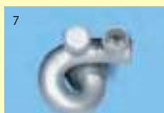
Сильное расширение во время фазы выгорания пластмассы-конкурента привело к отлому культы из паковочной массы в муфеле. Коронка заполнена после отливки металлом и непригодна к применению. На распили опоки видна отлитая на отломанной культе коронка (изображение 8).
